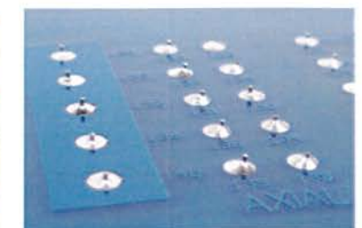
はんだの仕上がり例:美しいフィレットが形成されています。
